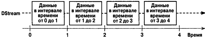
Рис. 10.2 ❖ DStream как последовательность наборов RDD
