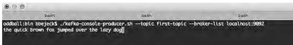
Рис. 2.20. Консольный генератор — замечательный инструмент для быстрого тестирования настроек и проверки сквозной функциональности
