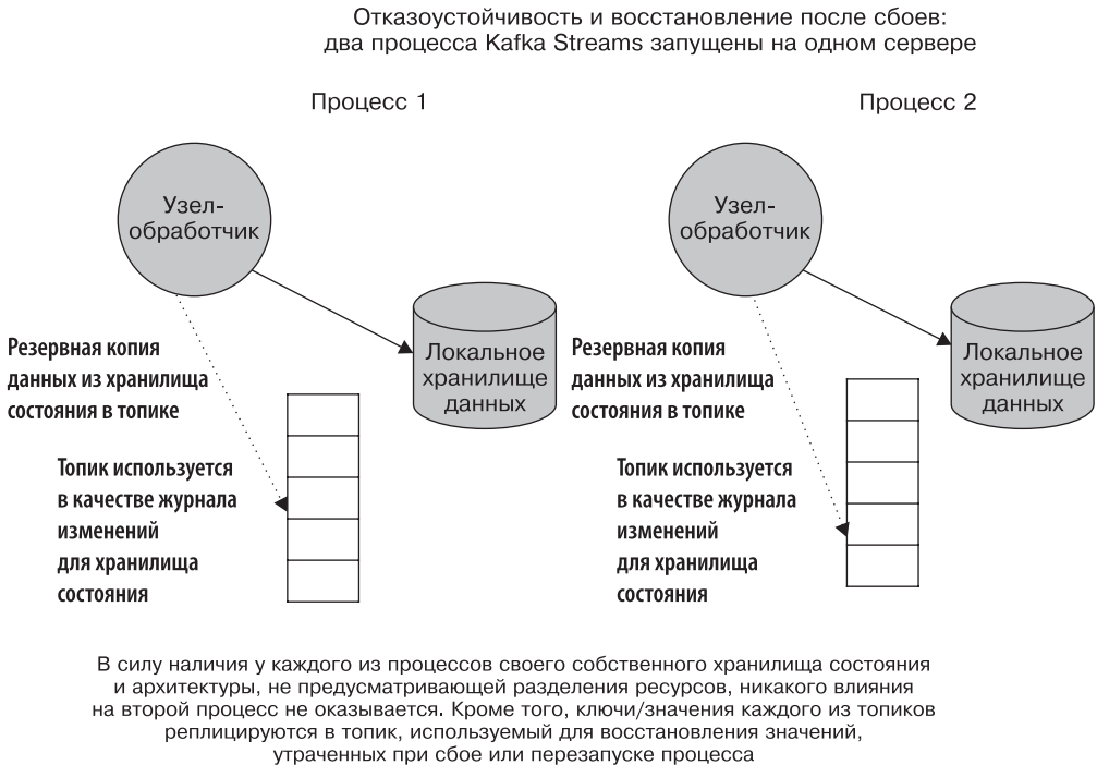
Рис. 4.10. Способность восстанавливаться после сбоев очень важна для потоковых приложений. Kafka Streams сохраняет во внутреннем топике данные из локальных хранилищ в оперативной памяти, так что при возобновлении работы после сбоя или перезапуска производится повторное заполнение данными
