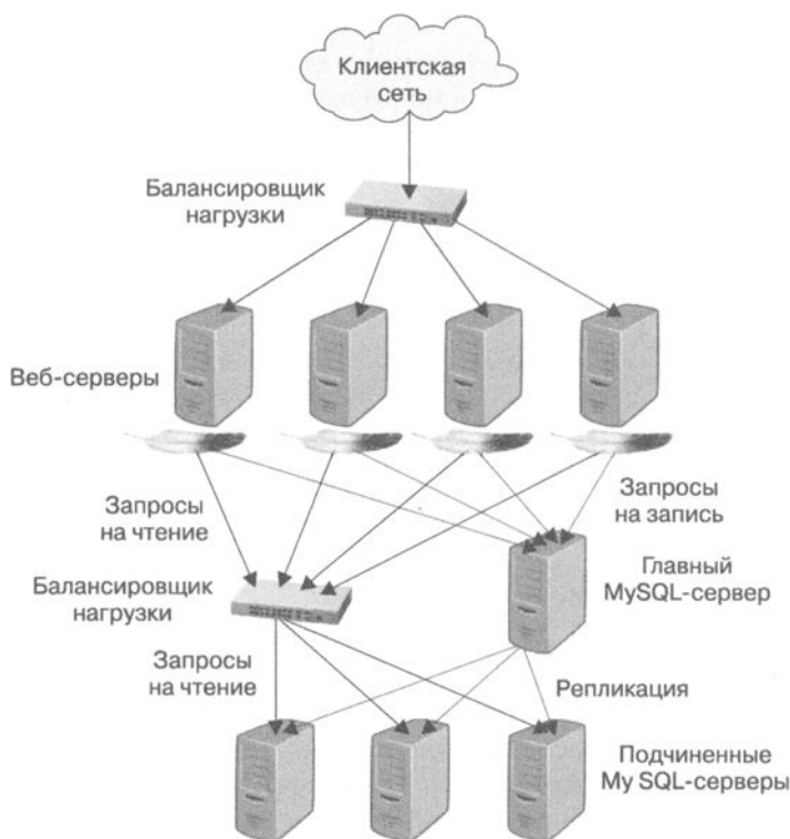
Рис. 11.9. Типичная архитектура балансирования нагрузки для сайта с большим количеством запросов на чтение
