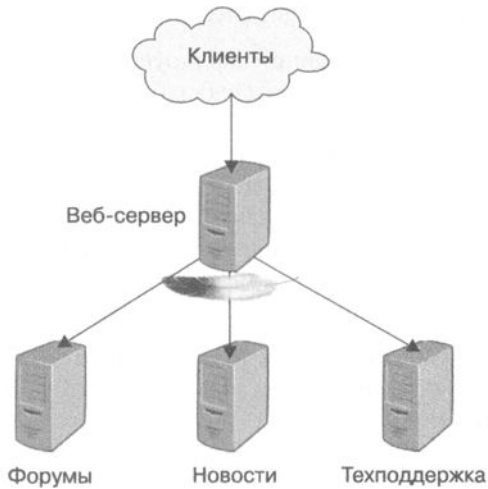
Рис. 11.5. Портал и узлы, выделенные под различные функциональные области
