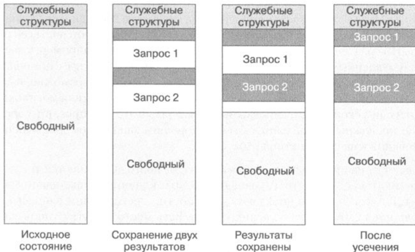
Рис. 7.4. Фрагментация, вызванная сохранением результатов в кэше запроса
