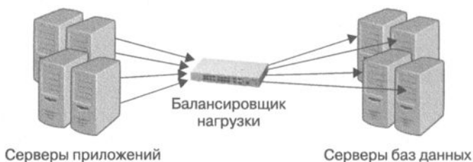
Рис. 11.10. Балансировщик нагрузки, работающий как посредник
