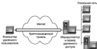
Рис. 8.6. Схема туннелирования при прямом подсоединении компьютера удаленного пользователя к Интернету
