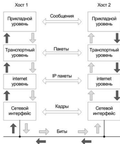
Рис. 8.2. Логические и физические соединения между уровнями стека TCP/IP
