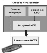
Рис. 11.4. Пример генерации одноразовых паролей на стороне пользователя
