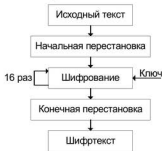
Рис. 4.5. Обобщенная схема шифрования в алгоритме DES
