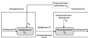
Рис. 4.18. Обобщенная схема асимметричной криптосистемы шифрования
