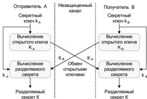
Рис. 4.26. Схема открытого распределения ключей Диффи–Хеллмана
