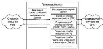
Рис. 9.8. Схема функционирования прикладного шлюза
