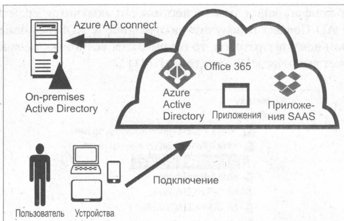
Рис. 1.11. Схема синхронизации AzureAD Connect
