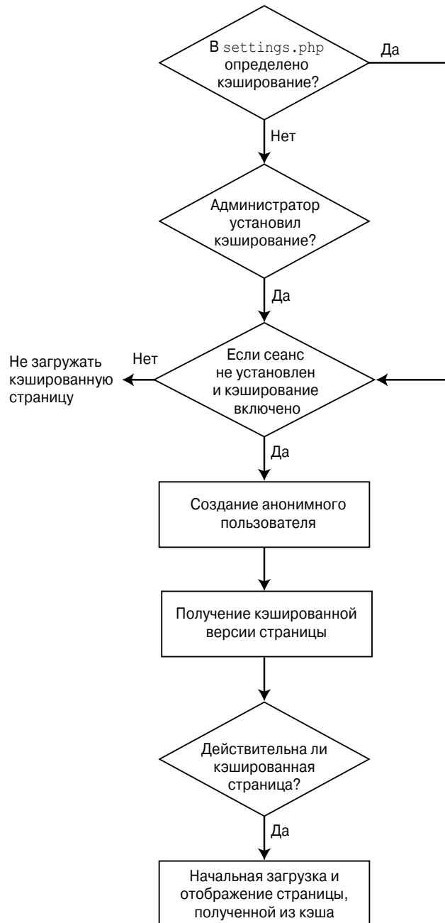
Рис. 16.2. Эта диаграмма демонстрирует жизненный цикл запроса анонимного пользователя, посетившего сайт, и процесс начальной загрузки Drupal, используемый для загрузки первой страницы, которую видит посетитель. На втором шаге процесса начальной загрузки Drupal пытается загрузить запрошенную страницу из кэша
