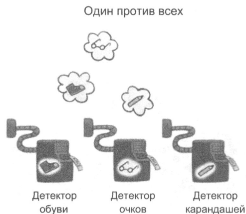
Рис. 4.16. «Один против всех» является методом многоклассовой классификации, от которого требуют определить каждую метку
