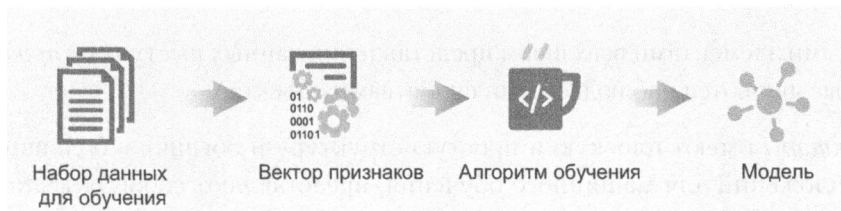
Рис. 1.4. Метод обучения обычно следует структурированному рецепту. Сначала набор данных необходимо преобразовать в представление, чаще всего — в список признаков, который затем можно использовать в обучающем алгоритме. Обучающий алгоритм выбирает модель и подбирает ее параметры наилучшим образом
