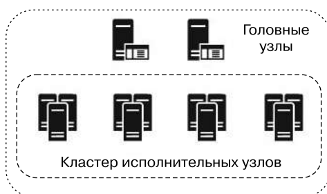
Рис. 3.5. Общая структура масштабируемой системы, построенной на основе кластера
