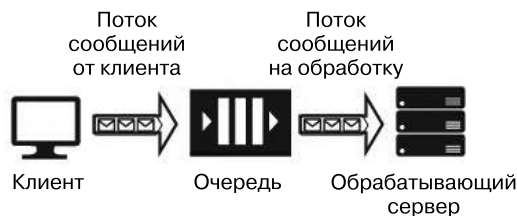
Рис. 10.1. Синхронизация клиента и обрабатывающего сервиса с помощью очереди
