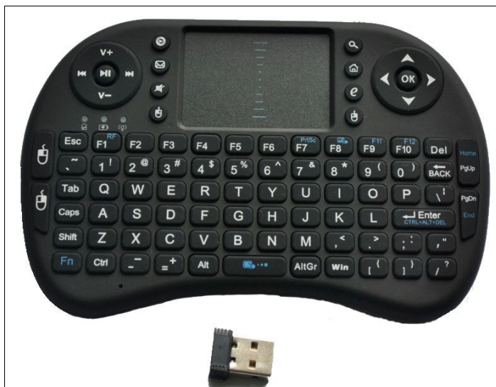
Рис. 3.7. Беспроводная мини-клавиатура со встроенным тачпадом
