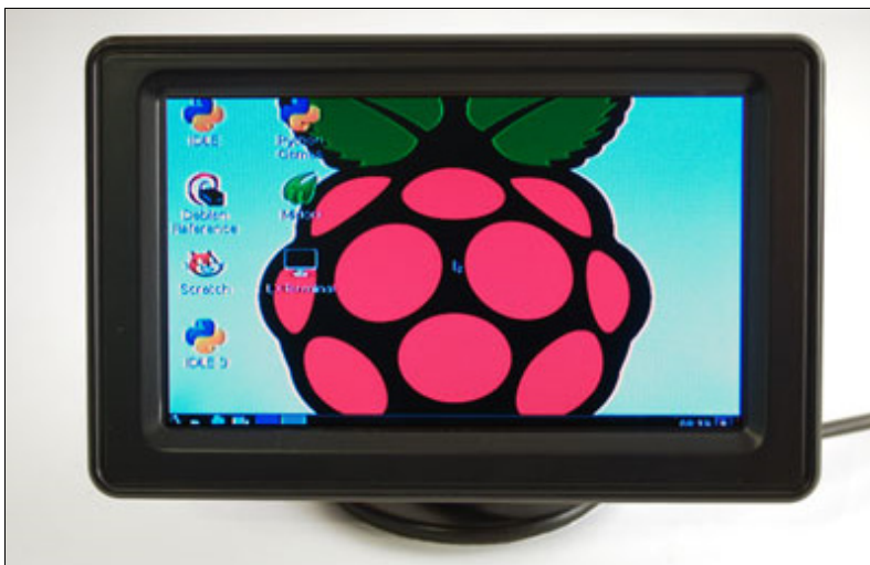
Рис. 3.9. Монитор 4,3" со входом RCA для Raspberry Pi
