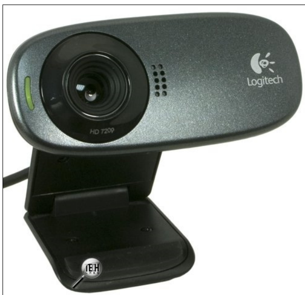
Рис. 4.24. USB веб-камера Logitech C270
