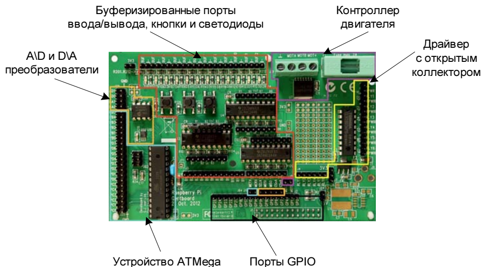
Рис. 6.23. Функциональные блоки платы Gertboard
