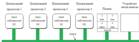
Рис. 6. 2. Разделение памяти мультимикропроцессора между четырьмя центральными процессорами с общей копией кода операционной системы
