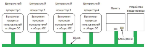
Рис. 6.4. Модель симметричного мультипроцессора
