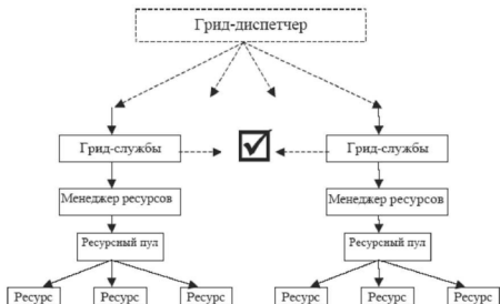
Рис. 7. 1. Двухуровневый горизонтально-интегрированный грид
