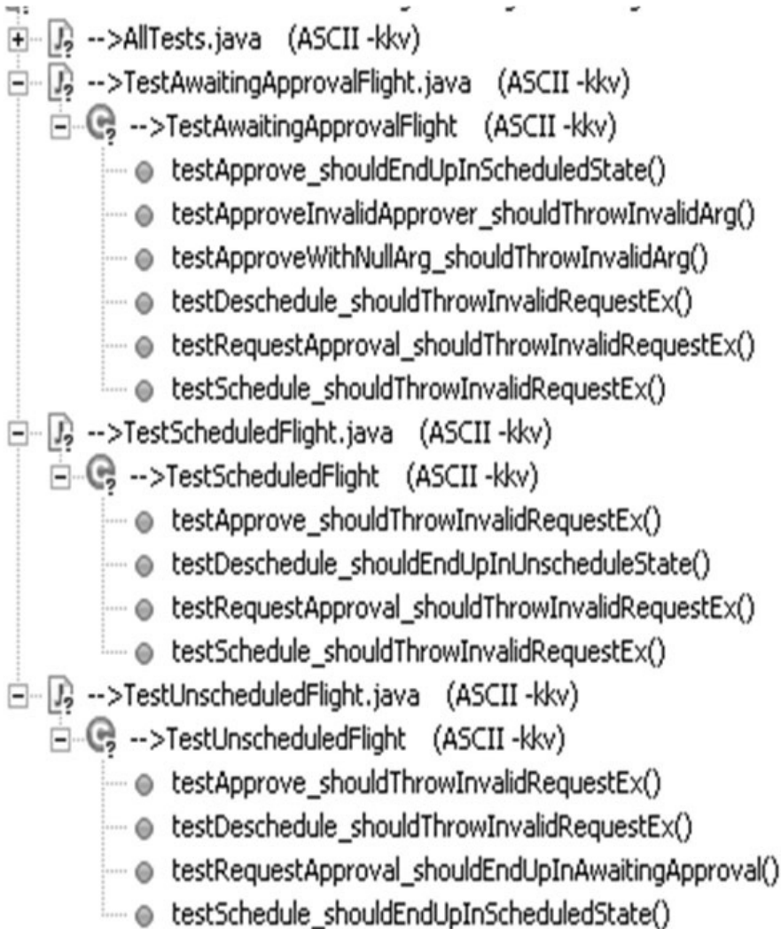
Рис. 24.2. Пример организации класса теста для каждой функции (Testcase Class per Feature) в окне Package Explorer среды разработки Eclipse. Обратите внимание, что в именах методов отсутствует имя проверяемого метода, что оставляет место для описания начального и ожидаемого конечного состояния
