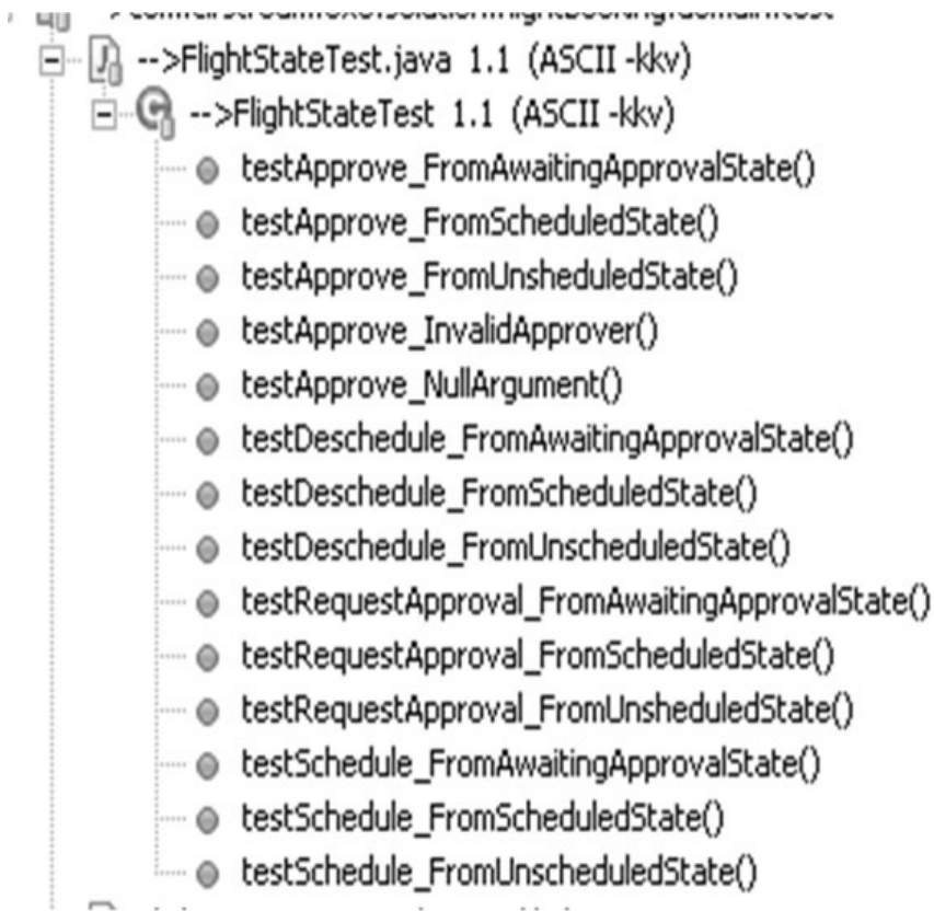
Рис. 24.1. Пример организации класса теста для каждого класса (Testcase Class per Class) в окне Package Explorer среды разработки Eclipse. Обратите внимание, что начальное состояние и проверяемое событие отражены в именах тестовых методов (Test Method)
