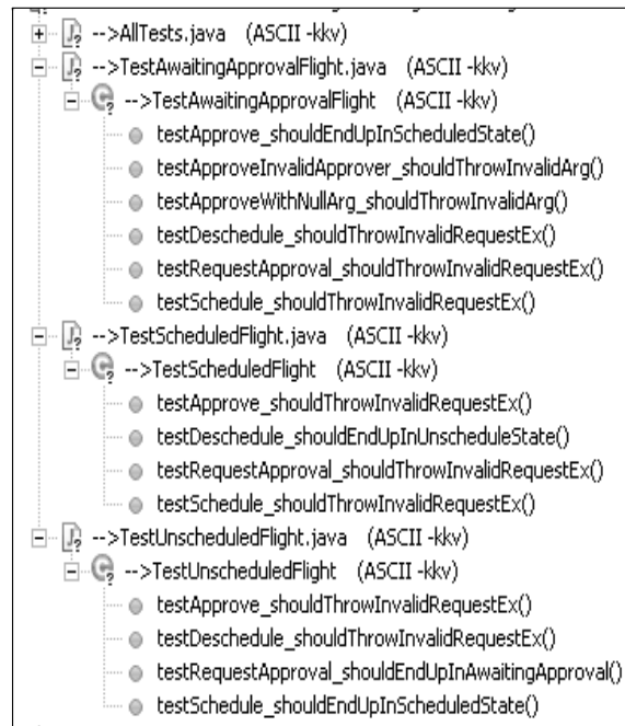
Рис. 12.5. Класс продукта и класс теста для каждой тестовой конфигурации. В такой ситуации имя класса может описывать тестовую конфигурацию, а имя метода описывает входные параметры и ожидаемый вывод
