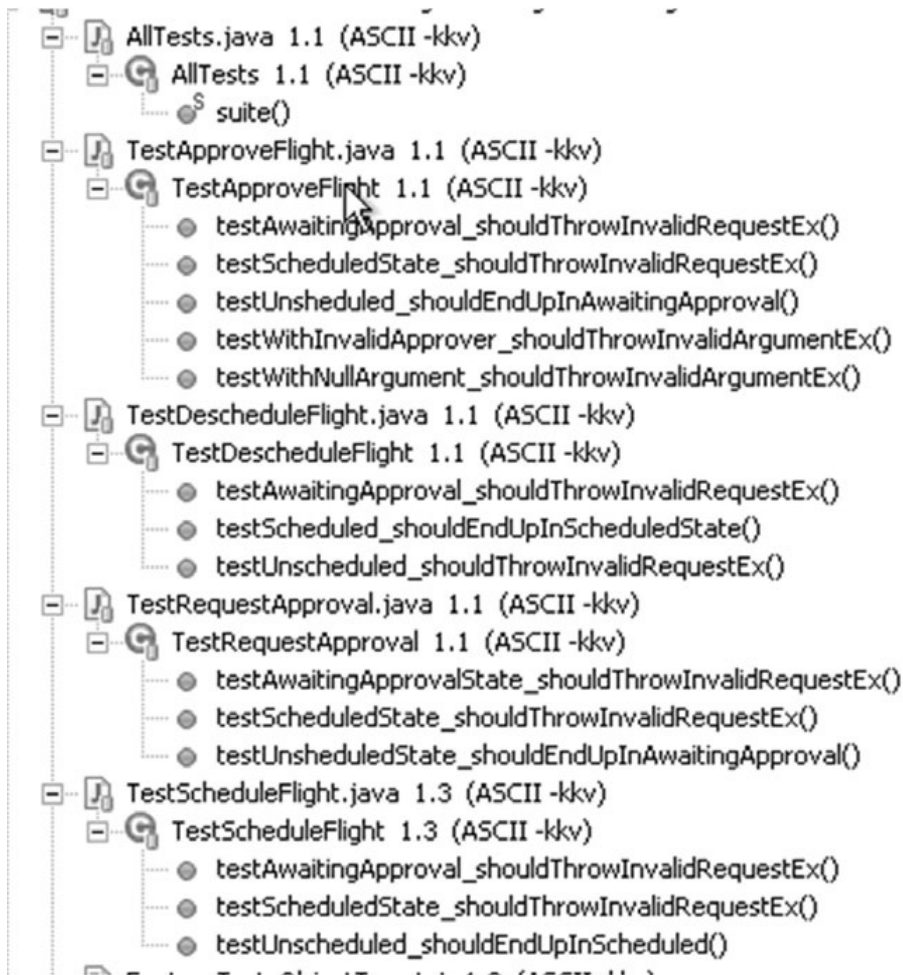
Рис. 24.3. Тесты, организованные в виде класса теста для каждой тестовой конфигурации (Testcase Class per Fixture) и показанные в окне Package Explorer среды разработки Eclipse. Обратите внимание, что в имени метода не указывается начальное состояние, что оставляет достаточно места для перечисления вызываемого метода и ожидаемого конечного состояния
