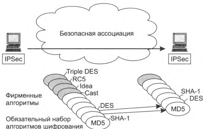
Рис. 29.11. Согласование параметров в протоколе ESP
