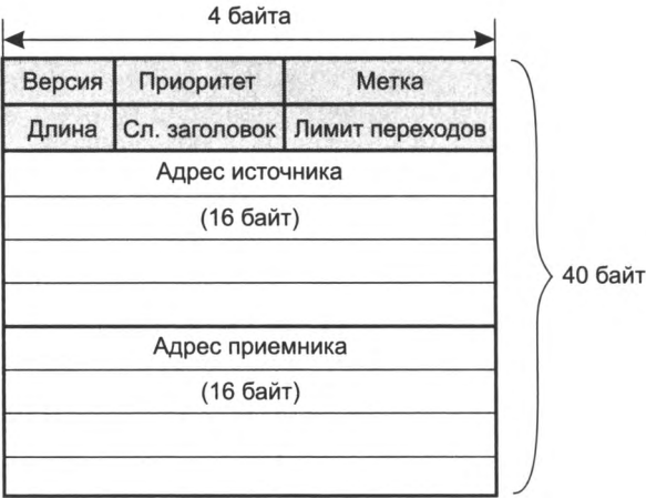
Рис. 17. 6. Формат основного заголовка
