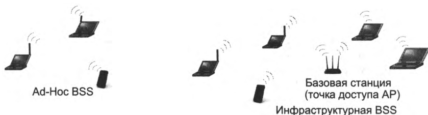
Рис. 22.3. Сети с базовым набором услуг: Ad-Hoc BSS и инфраструктурная BSS
