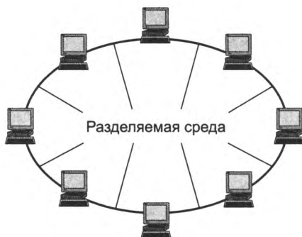
Рис. 10.2. Разделяемая среда в кольцевых топологиях
