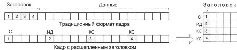
а) Схема представления кадра в виде матрицы
