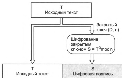
Рис. 27.6. Схема формирования цифровой подписи по алгоритму RSA
