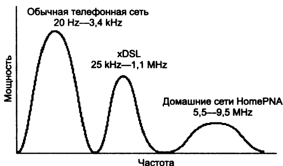
Рис. 4.3. Распределение частот для различных типов связи по телефонным кабелям
