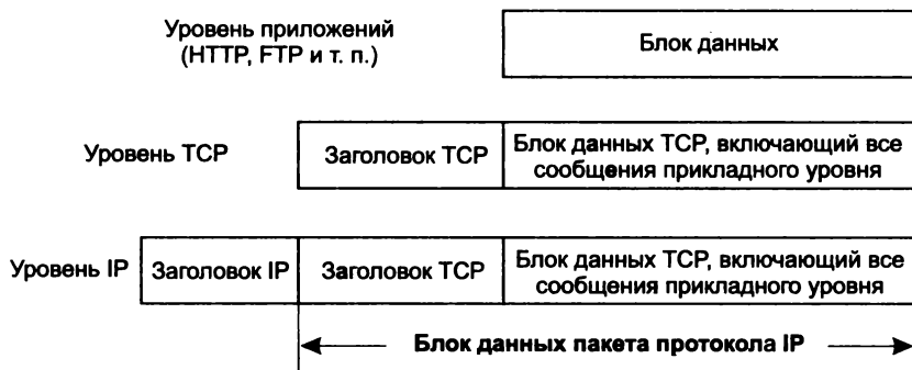
Рис. 5.8. Инкапсуляция протоколов верхнего уровня в протоколы TCP/IP
