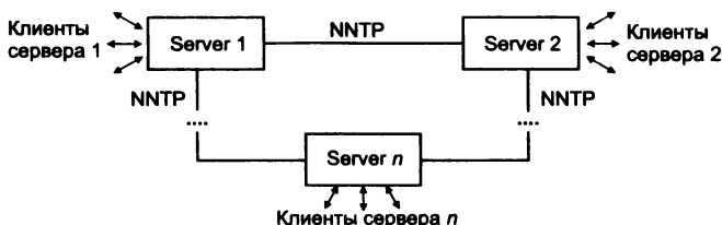
Рис. 6.11. Схема взаимодействия серверов Usenet
