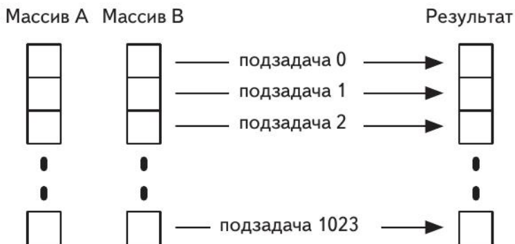
Рис. 28. Деление задачи перемножения элементов двух массивов на рабочие элементы
