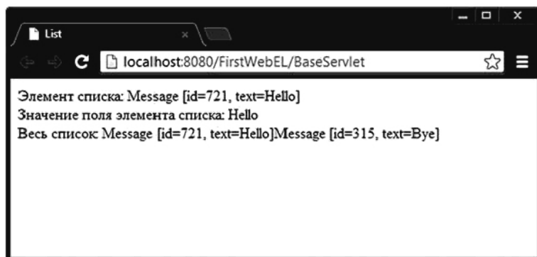
Рис. 16.3. Использование EL для доступа к элементам списка
