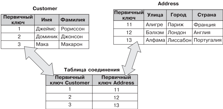
Рис. 5.9. Связь с использованием таблицы соединения
