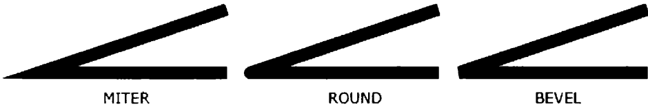
Рис. 5.3. Форма окончания в месте соединения двух линий (свойство strokeLineJoin )
