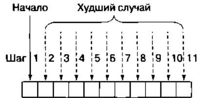
Рис. 2.2. В худшем случае при линейном поиске нужно последовательно просмотреть каждый элемент массива
