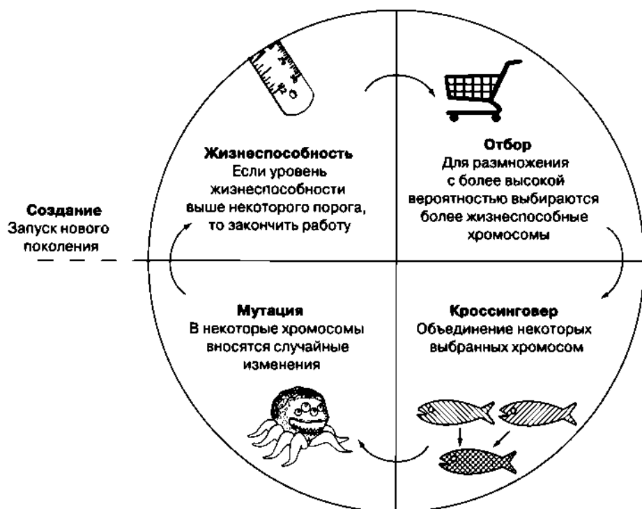
Рис. 5.1. Обобщенная схема генетического алгоритма
