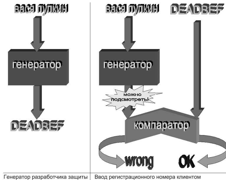
Рис. 2. Принцип работы регистрационной защиты
