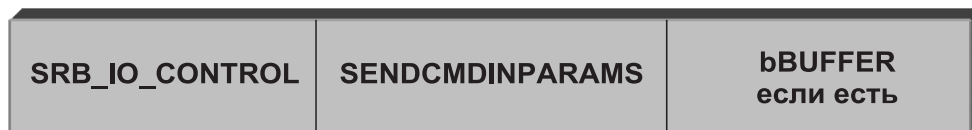
Рис. 22. Структура входного буфера функции DeviceIoControl для управления драйвером мини-порта под Windows 9x/NT
