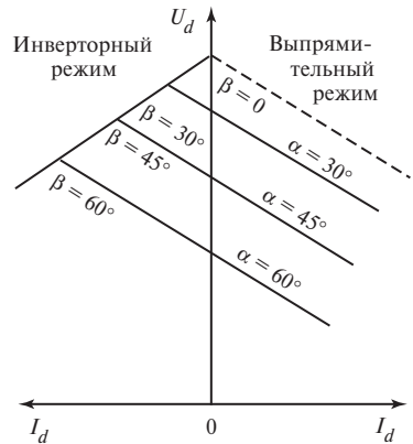
Рис. 12.16. Входные характеристики инвертора при L_d = \infty
