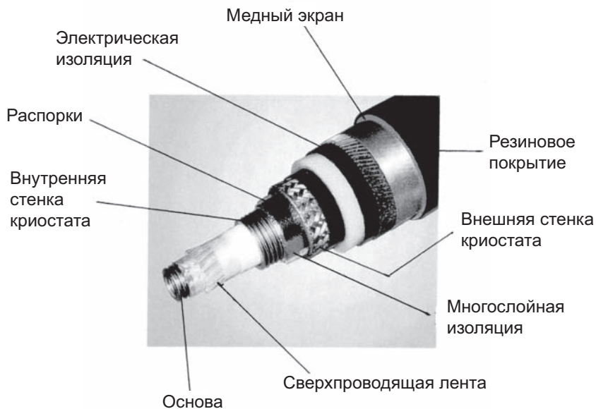
Рис. 16.1. Конструкция сверхпроводящего кабеля
