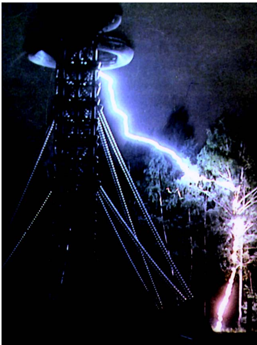
Рис. 15.16. Генератор импульсных напряжений на напряжение 6,0 МВ
