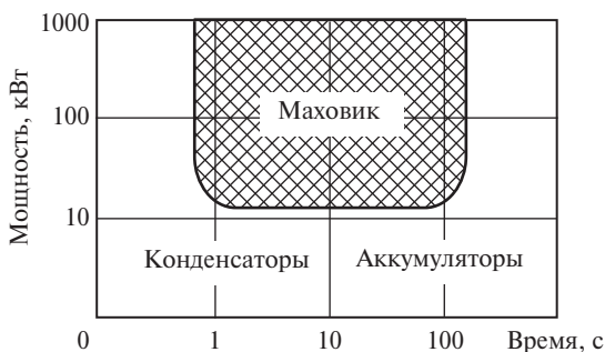
Рис. 18.5. Диаграмма сравнения маховиковых накопителей, конденсаторов и аккумуляторных батарей
