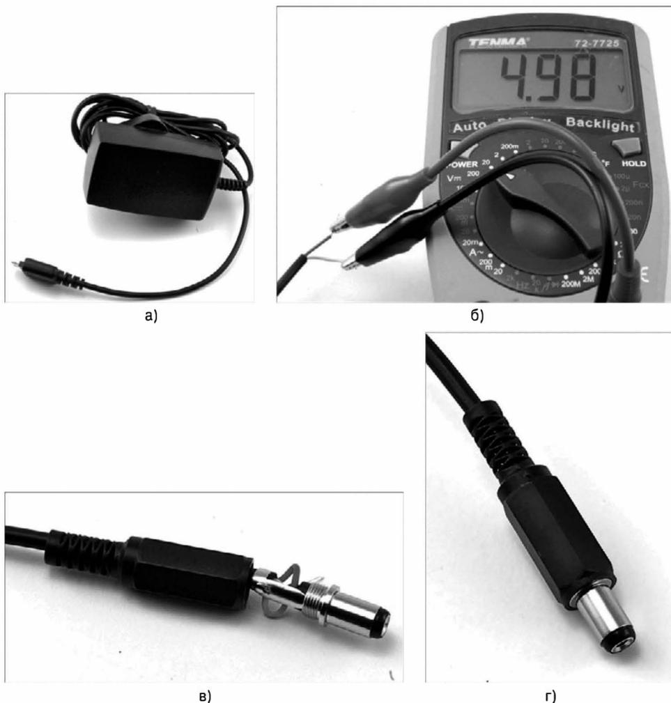
Рис. 10.7. Замена разъема на кабеле зарядного устройства
