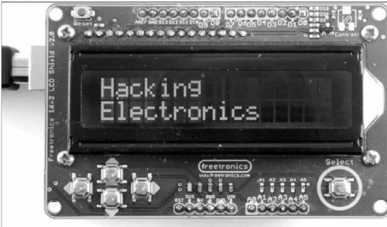
Рис. 6.28. Модуль с жидкокристаллическим алфавитно-цифровым дисплеем
