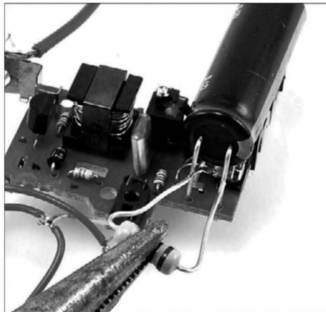
**Рис. 10.1.** Безопасная разрядка конденсатора
