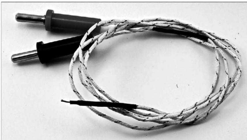
Рис. 11.3. Температура чаще всего измеряется термопарой
