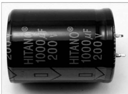
Рис. 2.4. Электролитический конденсатор
