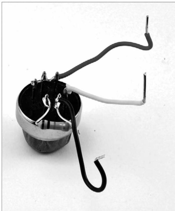
Рис. 8.3. Удлинение выводов датчика проводами
