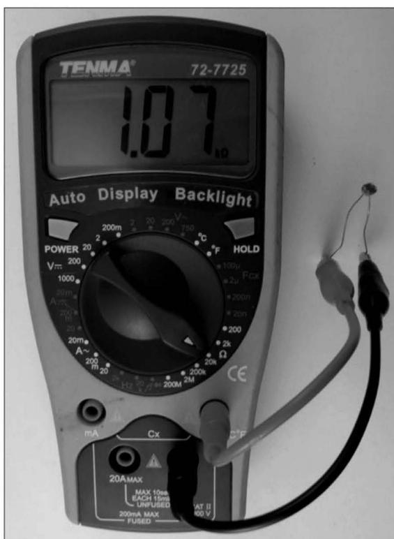
Рис. 3.8. Измерение сопротивления фоторезистора
