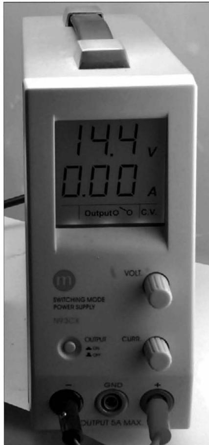
**Рис. 11.7.** Источник питания с плавно регулируемыми выходными параметрами
