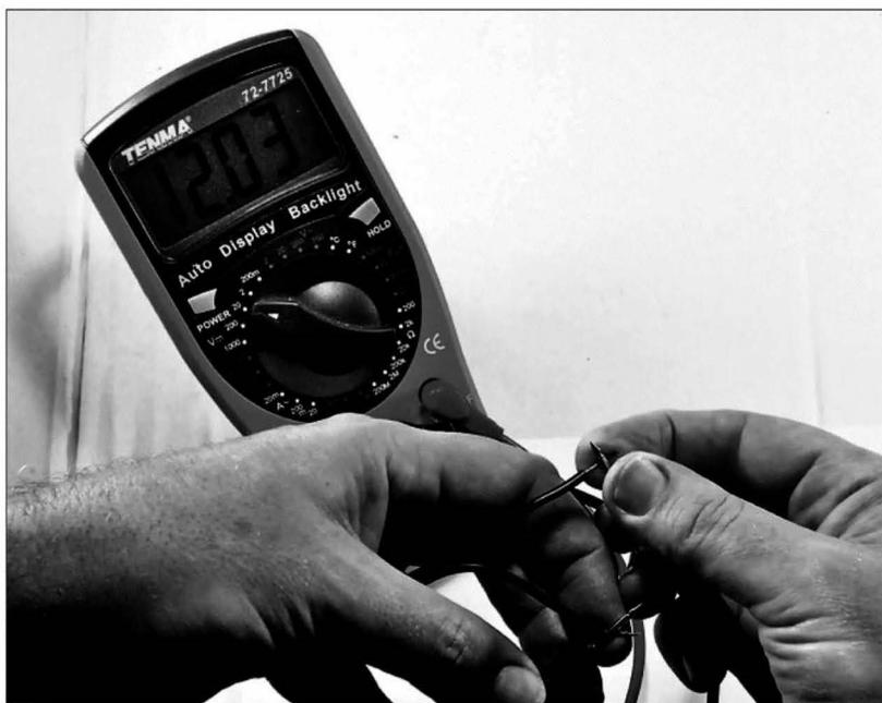
Рис. 1.13. Определение полярности источника питания с помощью мультиметра
