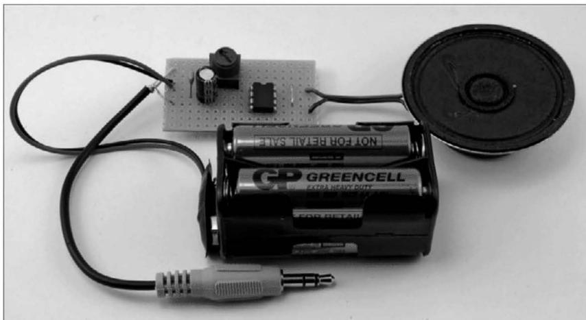
Рис. 9.13. Простейший звуковой усилитель мощностью 1 Вт
