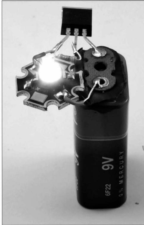
**Рис. 4.13.** Компактное устройство аварийного освещения помещения
