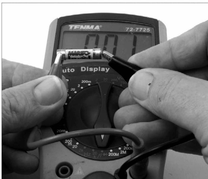
Рис. 10.3. Тестирование предохранителей
