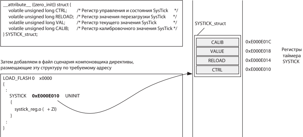
Рис. 10.5. Определение базового адреса периферийного устройства в файле сценария компоновщика.
