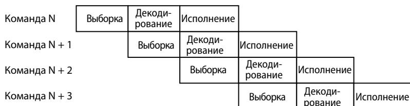
Рис. 6.1. Трёхступенчатый конвейер процессора Cortex-M3.
